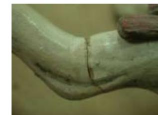
圖12 斷裂後黏合之黏膠溢出
